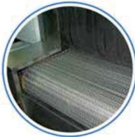
Полотно транспортера изготавливается из прочной нержавеющей цепи с открытыми ячейками не менее 15x15 мм и имеет дополнительные опоры – ролики, что позволяет выдерживать нагрузку не менее 100 кг на метр длины транспортера. Транспортер приводится в движение червячным мотор-редуктором и имеет натяжную станцию. Скорость движения транспортера может регулироваться в диапазоне 1-6 м/мин.
