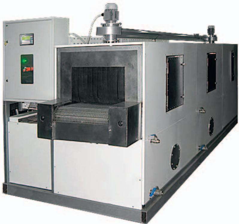
Струйная моечная машина проходного типа предназначена для мойки деталей в массовом производстве. Детали поступают в зону обработки по конвейеру. Скорость транспортёра 1-6 м/мин. Количество стадий обработки (мойка, ополаскивание, пассивация, сушка) зависит от комплектации машины и характеристикам применяемых растворов. Все механические узлы и детали машины, контактирующие с водой и моющими растворами, выполнены из нержавеющей стали.
