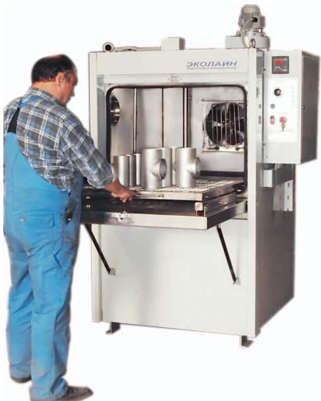
Рабочая камера имеет выдвижную платформу, которая позволяет производить загрузку изделий снаружи.
