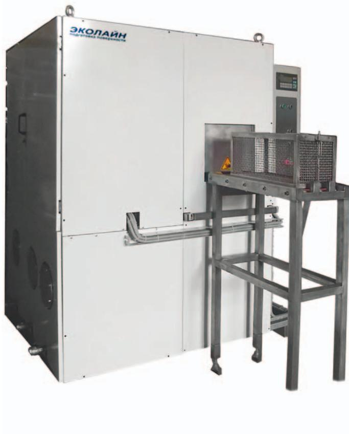
Автоматическая моечная машина предназначена для погружной и струйной мойки деталей в сетчатых корзинах в герметичной рабочей камере в среде перхлорэтилена. Установка корзин с деталями в моечную камеру машины и снятие их после цикла мойки производится вручную. Машина может комплектоваться загрузочным столом с роликом.
