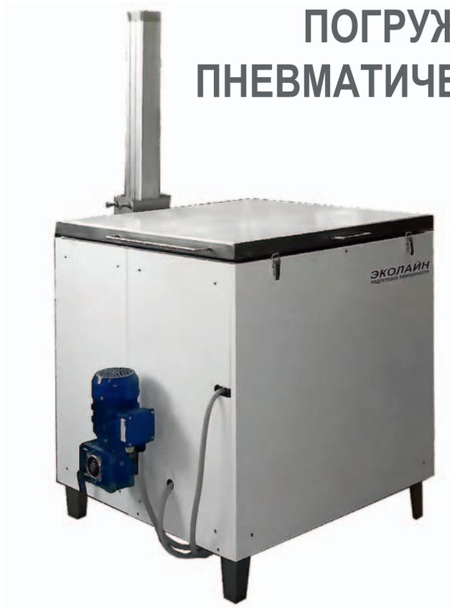
Моечная машина предназначена для погружной мойки и подготовки поверхности деталей. Представляет собой резервуар, оснащенный подъемной платформой с пневматическим приводом. Вертикальные перемещения платформы в процессе обработки способствуют постоянному обновлению растворов у поверхности деталей. Для перезагрузки деталей платформа поднимается в плоскость верхнего проема камеры, облегчая тем самым перезагрузку и транспортировку деталей.
