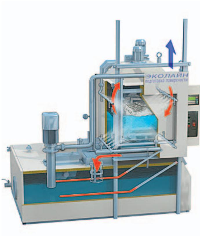
Моечные машины предназначены для погружной и струйной мойки деталей в сетчатых корзинах. Моечная (рабочая) камера имеет сдвижную дверь с электроприводом.
